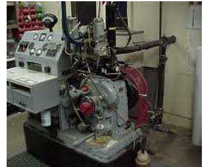
Változtatható kompresszió viszonyú CFR motor
